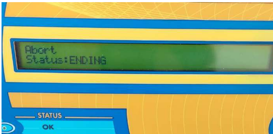
Figura 15 - La procedura di interruzione procede secondo una sequenza di interruzione predefinita che prevede lo scarico dei filtri eventualmente presenti sul piatto di campionamento.
