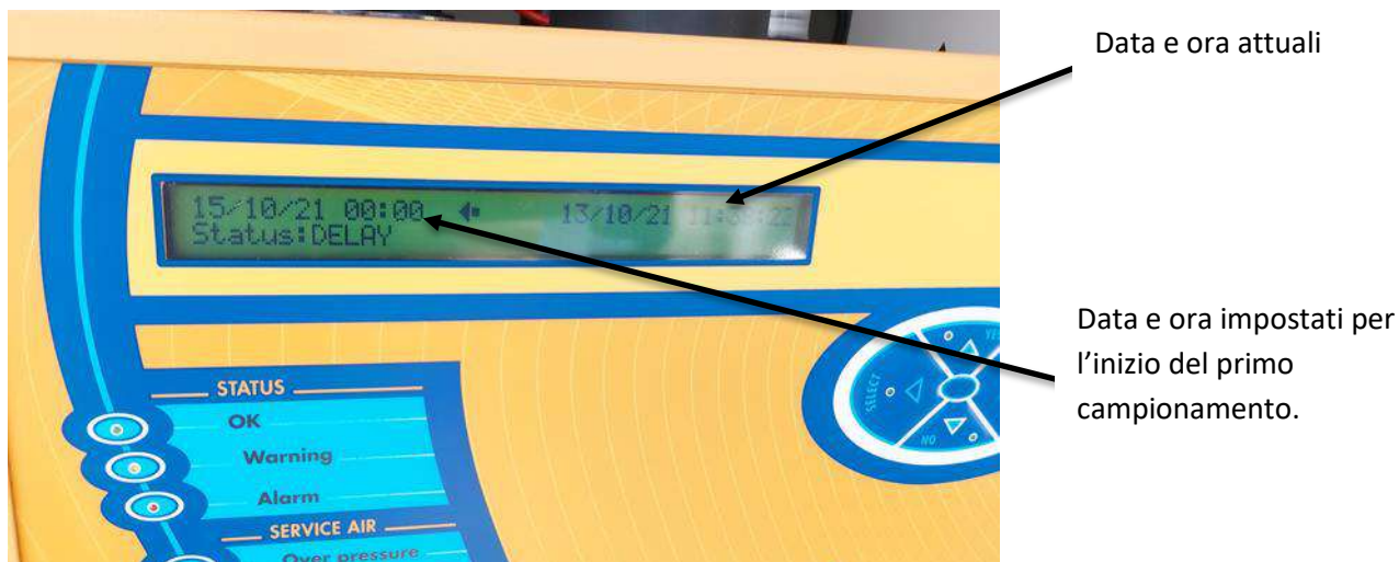
Figura 10 - Indicazione dello stato di attesa di inizio del primo campionamento dopo salvataggio delle impostazioni del nuovo ciclo di campionamento.
