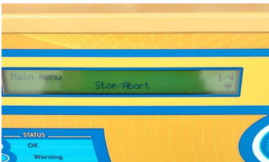
Figura 12 - Menu principale selezionabile mentre lo strumento si trova in fase di attesa.
