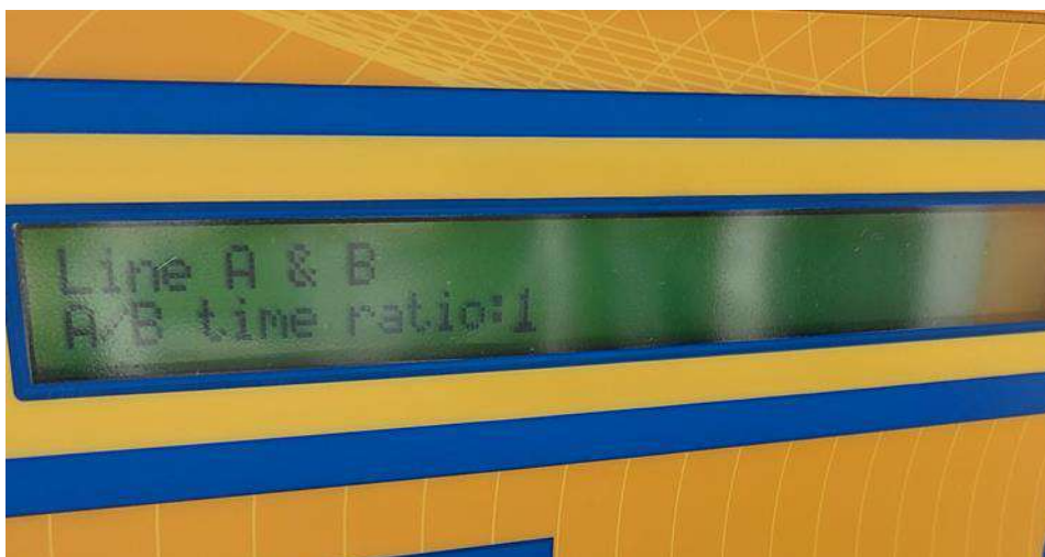
Figura 6 - selezione del rapporto temporale di campionamento tra le due linee. Selezionare una durata simile ossia rapporto pari a 1.
